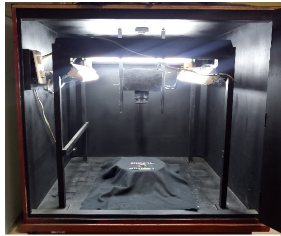
Figura 16. Equipo de visión computacional
