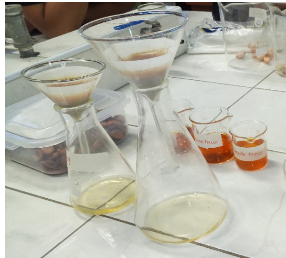
Figura 28. Filtrado de líquido para medir pH y % de acidez
