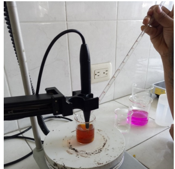
Figura 31. Medición del % de acidez de muestras de cacao fresco y fermentado
