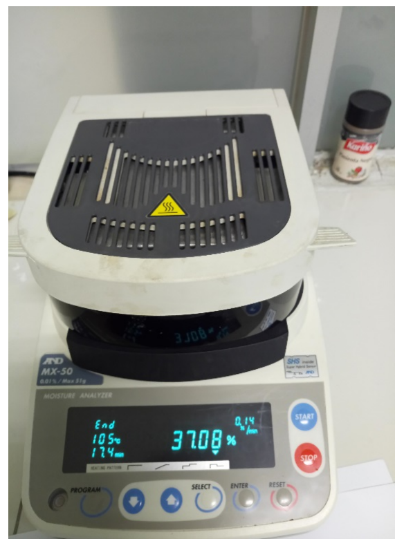
Figura 12. Analizador automático de humedad A&D ML-51
