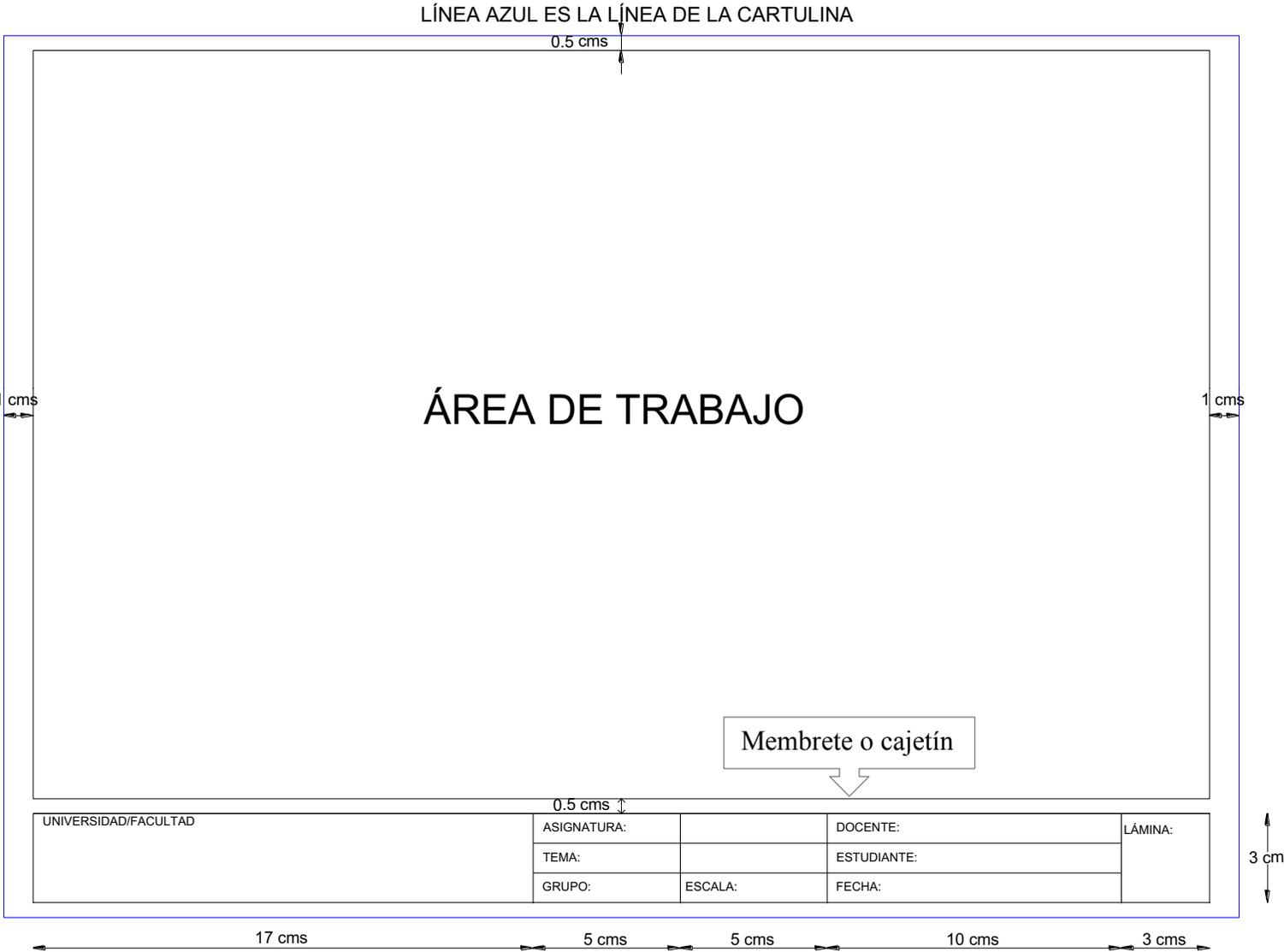
Ilustración 31.- Cajetín en Lámina formato A3 Ejemplo 2
